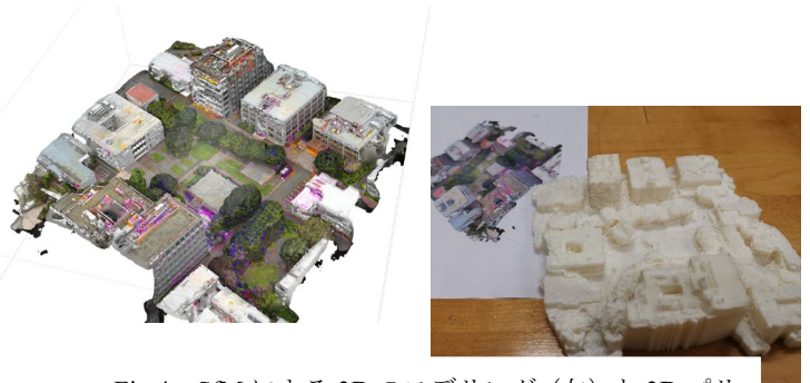
Fig.4 SfM による 3D のモデリング (左) と 3D プリント (右)
